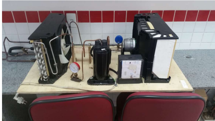
Figura 3 - Bancada de um sistema de refrigeração residencial.
