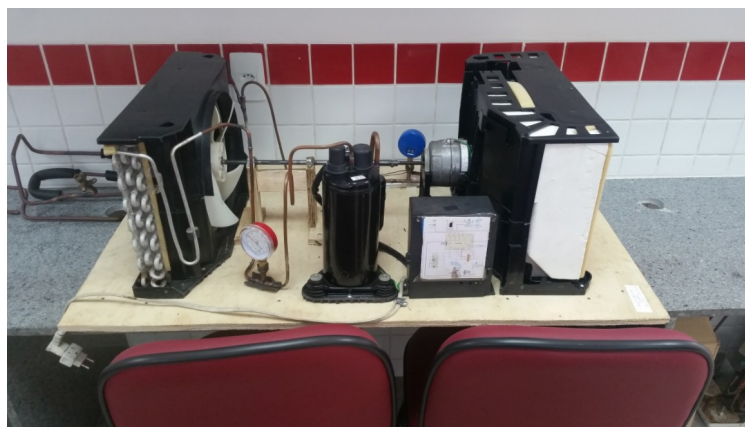
Figura 3 - Bancada de um sistema de refrigeração residencial.
