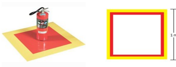
Figura 1: Modelo de sinalizações para extintores
