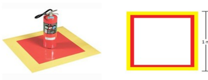
Figura 1: Modelo de sinalizações para extintores
