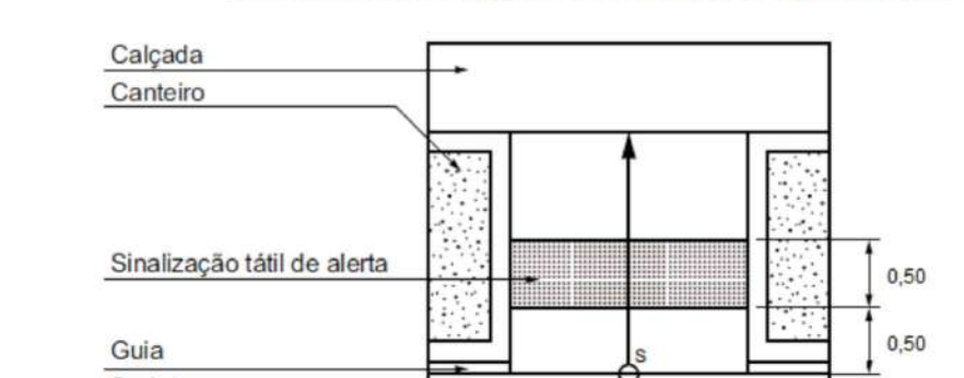
Rebaixamento de calçada com canteiro
