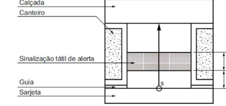
Rebaixamento de calçada com canteiro
