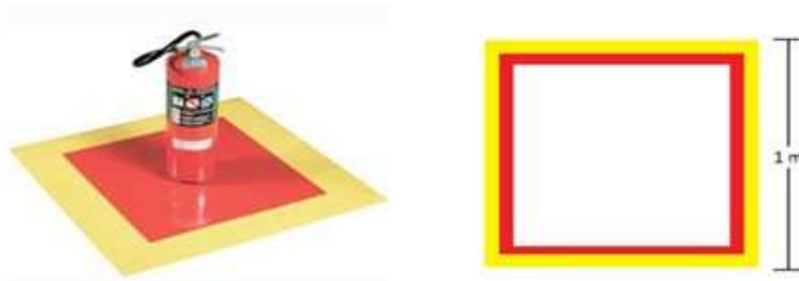
Figura 1: Modelo de sinalizações para extintores
